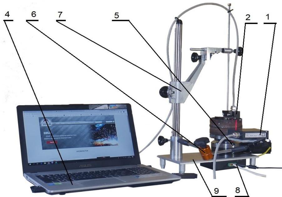
Сканер LST предназначен для бесконтактного измерения и оцифровки лицевой и корневой поверхности сварного шва стыковых КСС труб, для последующей оценки по технологии 3DLD практических навыков сварщиков, при сварке плавлением.
